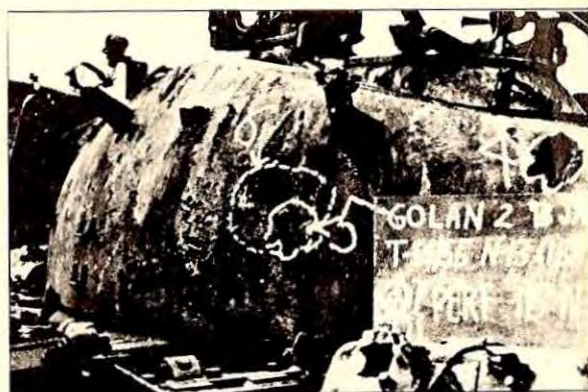
Bildet viser en T-55 som er truffet av APFSDS granater fra en T-62.
