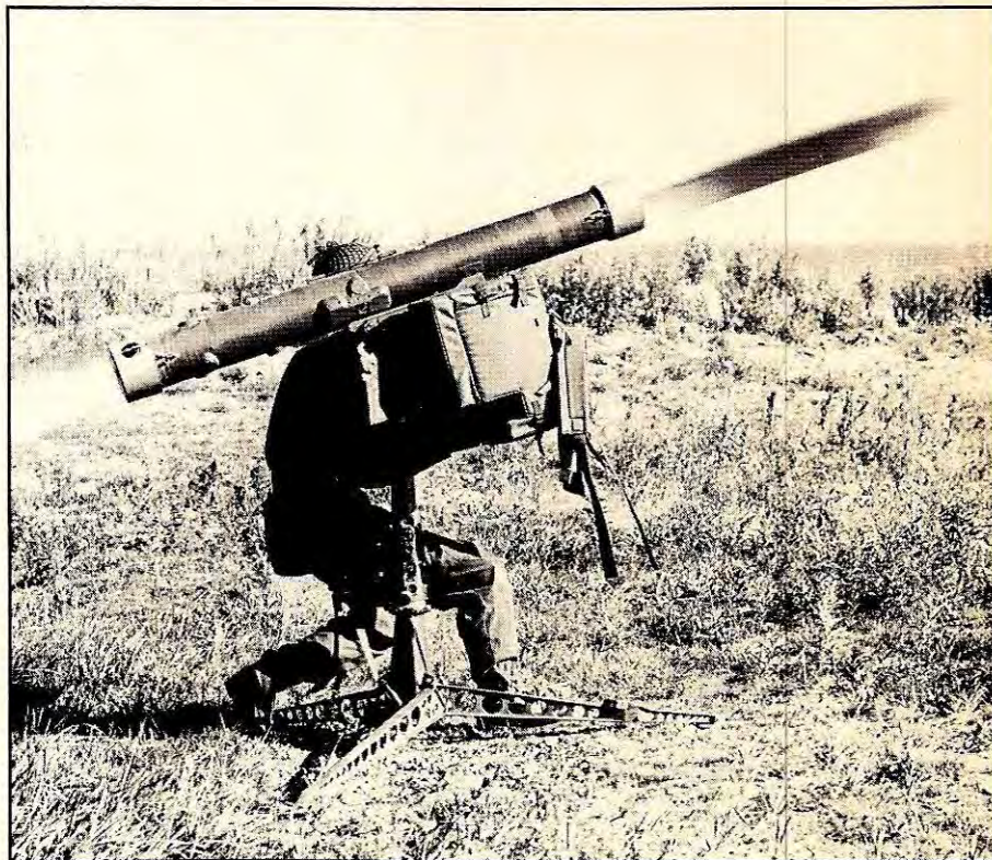
Bærbart laserstyrt luftvernrakett fra Bofors. Innføres som lett luftvern for de norske feltbrigadene og muligens for enkelte flyplasser. Dette er et kortholdsystem og bør brukes sammen med systemer med lengre rekkevidde.
